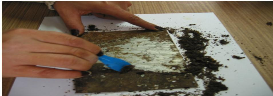
**Fig. 2** Eliminación mediante raspado de la grasa **DISTIN 314S** aplicada sobre una probeta de acero, después de tres años de exposición en obra soterrada.
