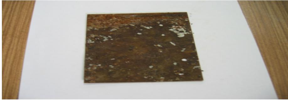
**Fig. 1** Probeta con grasa **DISTIN 314S** retirada después de tres años de exposición en obra soterrada.
